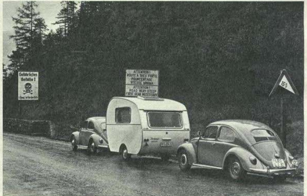
Außergewöhnliche Bremsversuche am Zirler Berg: Mit Scheibenbremsen, mit serienmäßigen Trommelbremsen und mit angehängtem Wohnwagen im Leerlauf hinunter – beide Bremsen halten das klaglos durch. Sie sind selbst mit Wohnwagen nicht überfordert.
